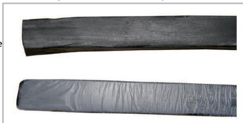
Sammenligning fugebånd med og uden beskyttelsesfolie
